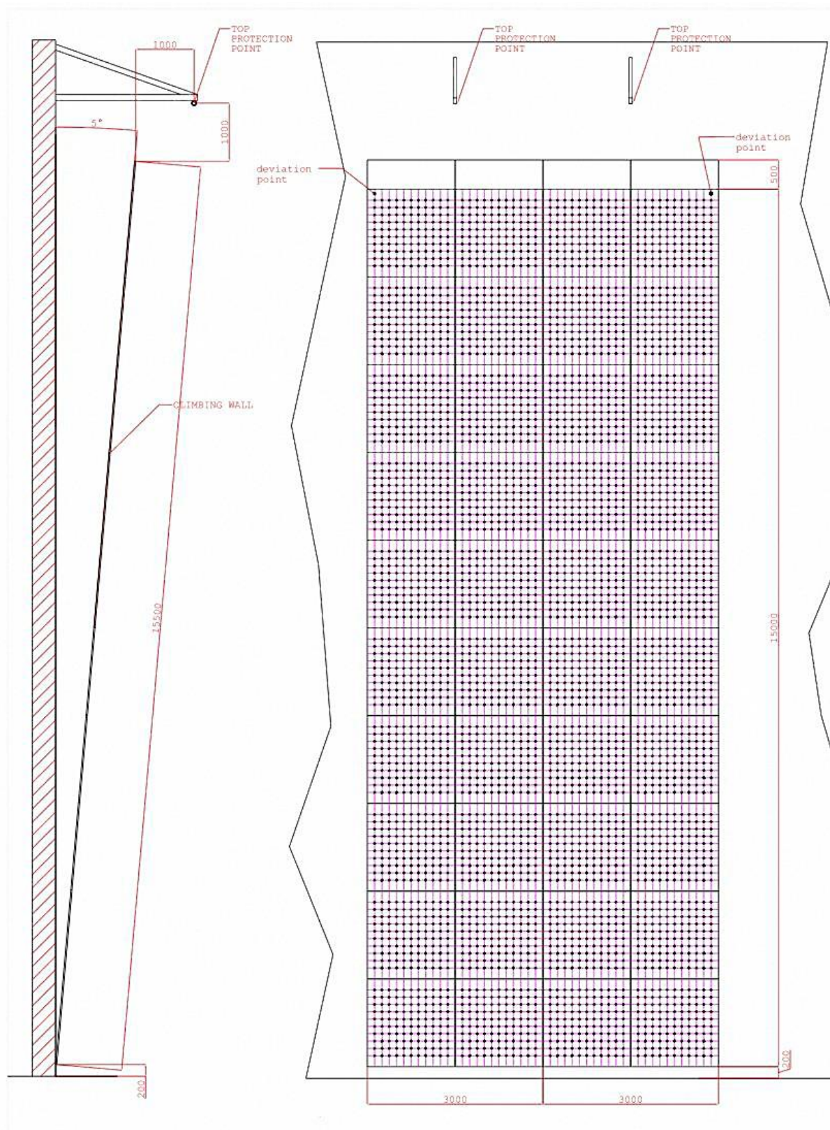
図 8.2 (a) 15m 競技用レーン
